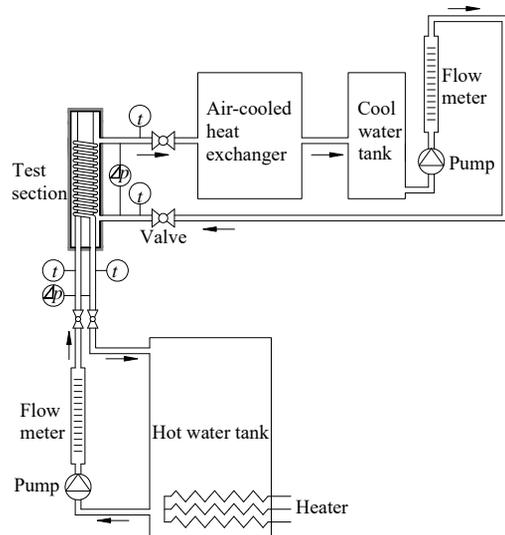
**Fig. 2: Experimental apparatus**
